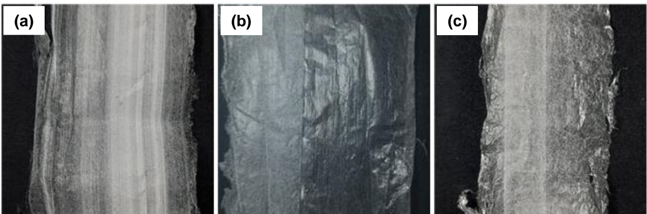
Figura 27. Imagens das membranas obtidas: (a) sem translação, (b) translação de 15 cpm, (c) translação de 30 cpm. Vazão de solução de 0,5 mL/min, tensão de 20 kV e distância da agulha até o coletor de 15 cm.
