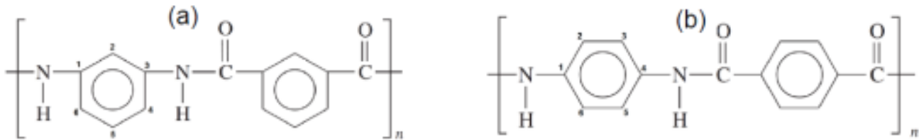
Figura 2. Fórmula estrutural da molécula de aramida: (a) meta-aramida e (b) para aramida.
