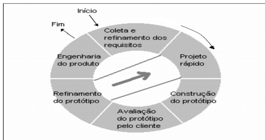
Figura 3: Modelo Prototipação. Fonte: PRESSMAN, R. (1995, p. 39)
