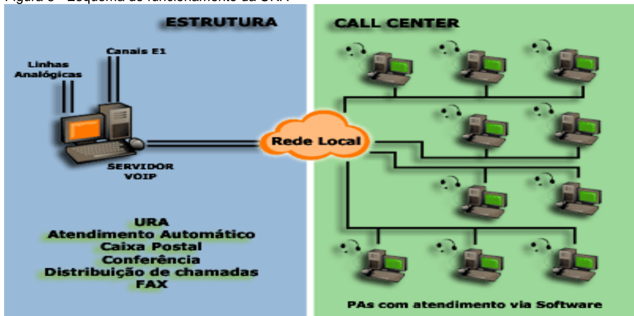
Figura 8 - Esquema do funcionamento da URA
