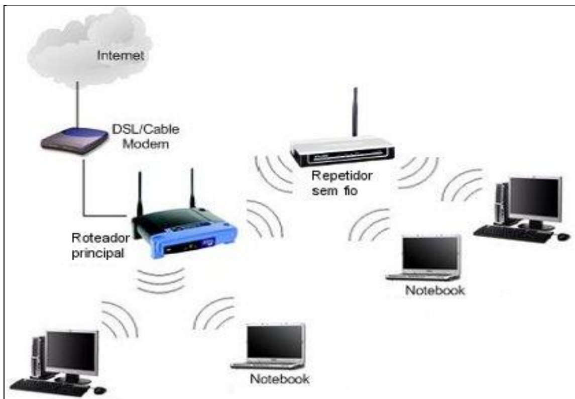
Figura 1. Diagrama de uma rede sem fio com repetidor Fonte: Augusto Campos (2009).
