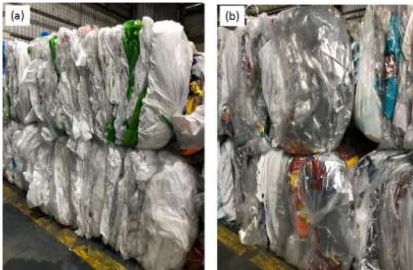
Figura 6 - Filmes poliméricos laminados nas estruturas (a) PE//PE (b) PE//PET Met//PET
