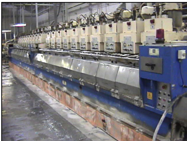
Figura 20. Parte Exterior de uma politriz Fonte: Arquivo pessoal
