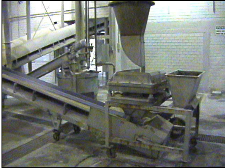
Figura 7. Correia transportadora de massa atomizada Fonte: Arquivo pessoal
