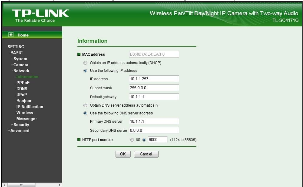
Figura 23 - Endereçamento IP da câmera pela conexão cabeada e da porta de comunicação.
