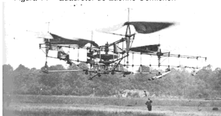
Figura 14 – Quadrotor de Etienne Oehmichen
