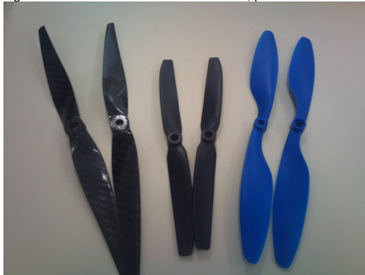
Figura 20 - Hélices de diferentes materiais, passos e tamanhos.
