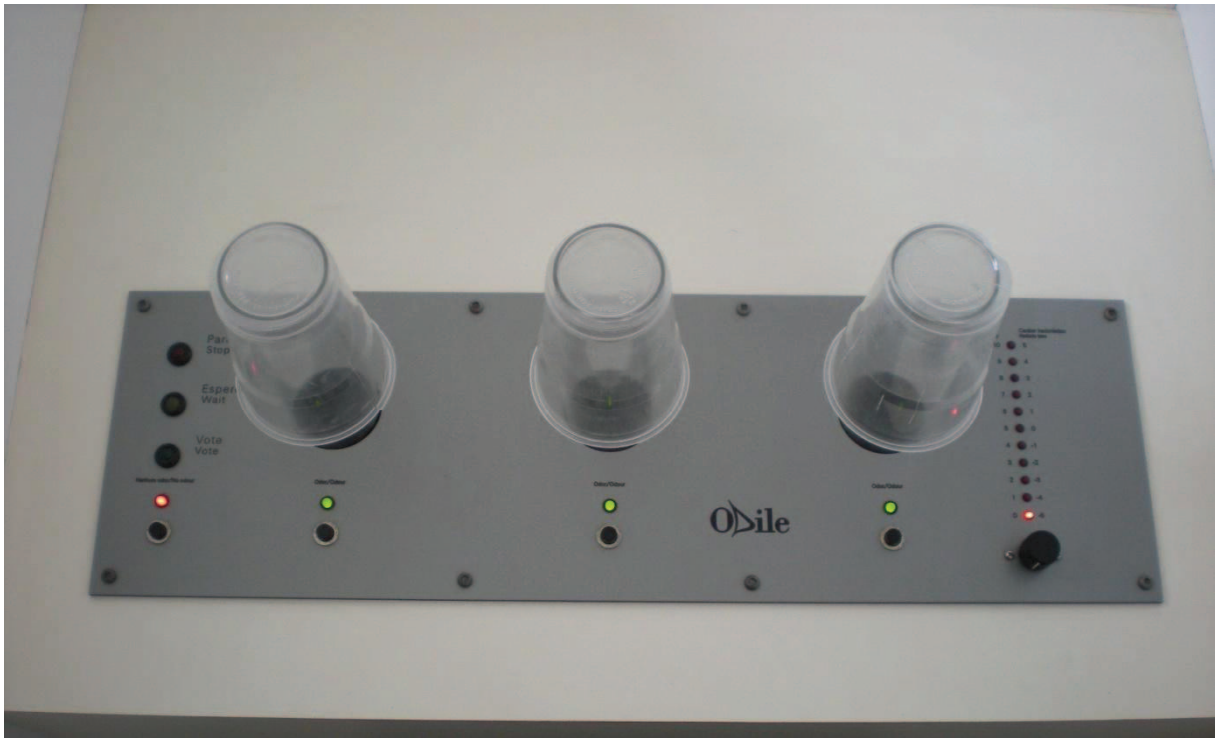
Figura 10: Painel da mesa olfatométrica.
