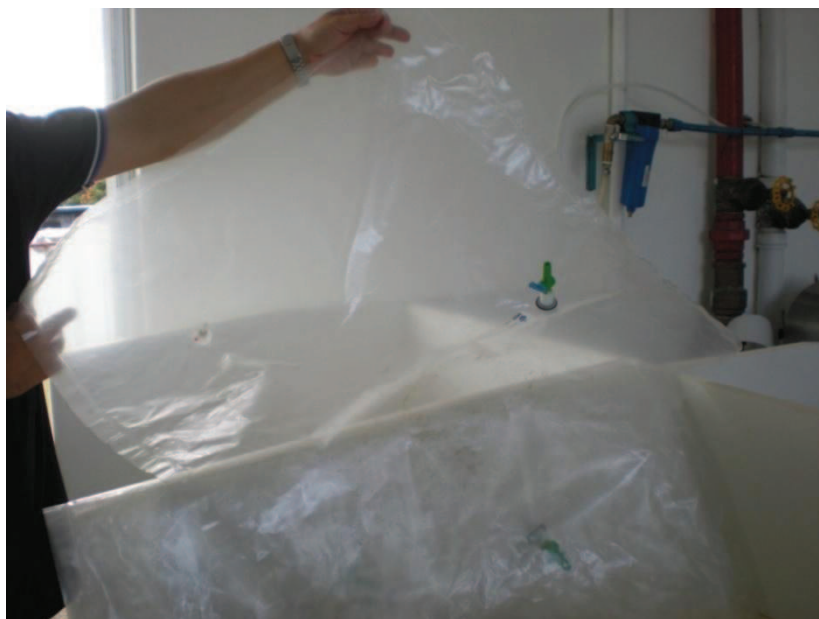
Figura 4: Saco Tedlar® para amostragem de odor.
