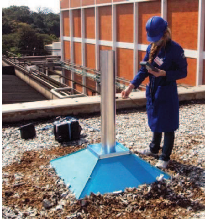
Figura 8: Campânula amostradora de emissões odorantes instalada para monitorar um biofiltro.
