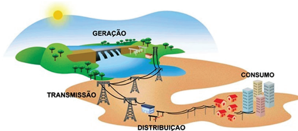
Figura 3 – Sistema de distribuição de energia elétrica.
