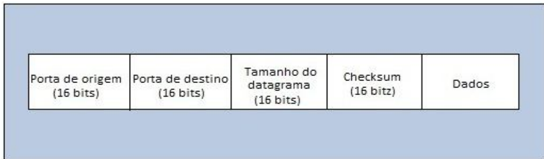
Figura 3. Estrutura do Datagrama UDP
