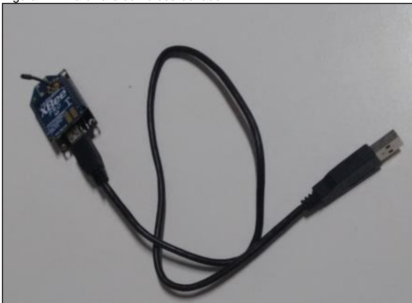
Figura 12 - Hardware do nó coordenador.
