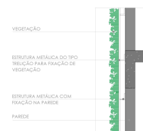
DETALHE JARDIM VERTICAL ESCALA 1:20
