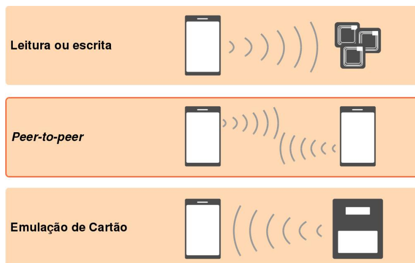
Figura 2. Modos de operação dos dispositivos NFC
