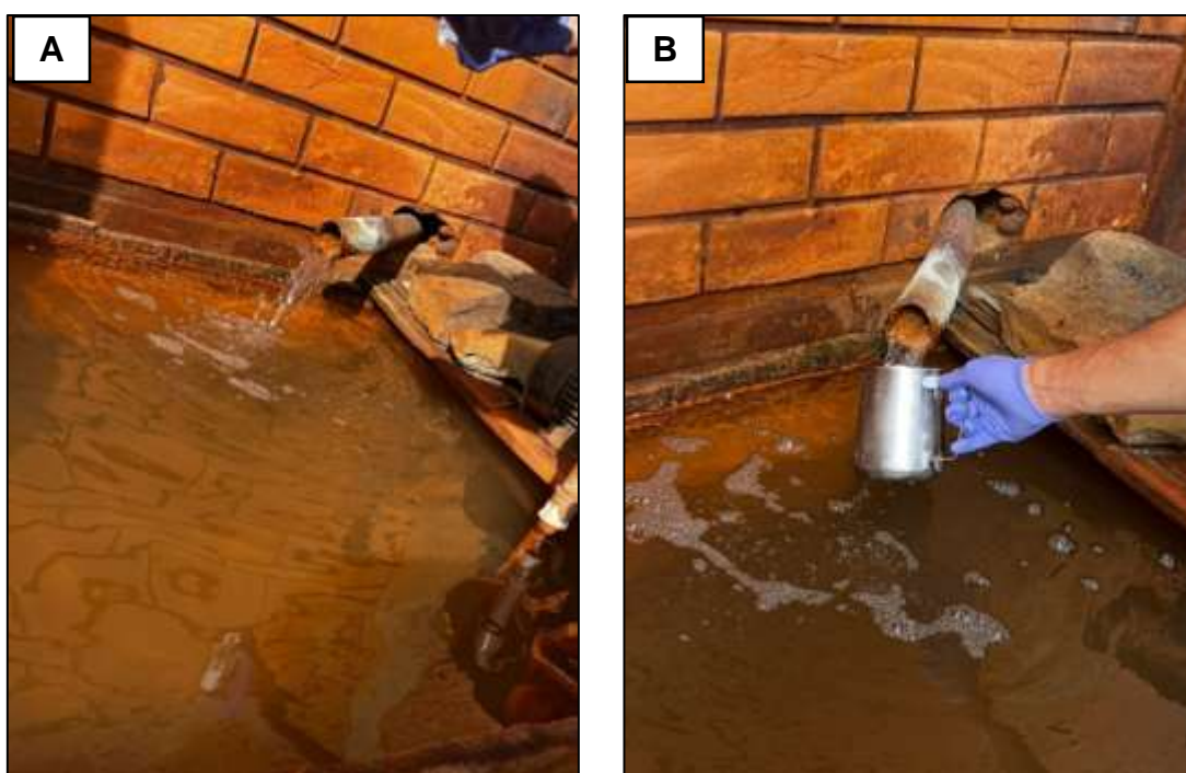
Figura 13 – A: Ponto de amostragem; B: Coleta da amostra
