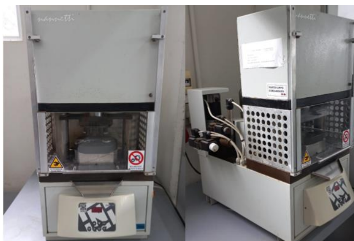
Figura 22: Prensagem dos corpos de prova Fonte: (O autor, 2023).
