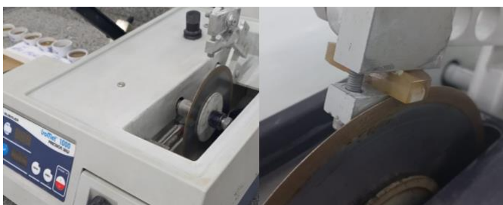
Figura 27: Dispositivo para corte das amostras Fonte: (O autor, 2023).
