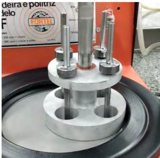
Figura 28: Acessório da máquina de polimento Fonte: (O autor, 2023).
