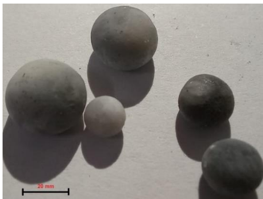
Figura 37: Materiais obtidos por tempera rápida ( quenching ) Fonte: (O autor, 2023).
