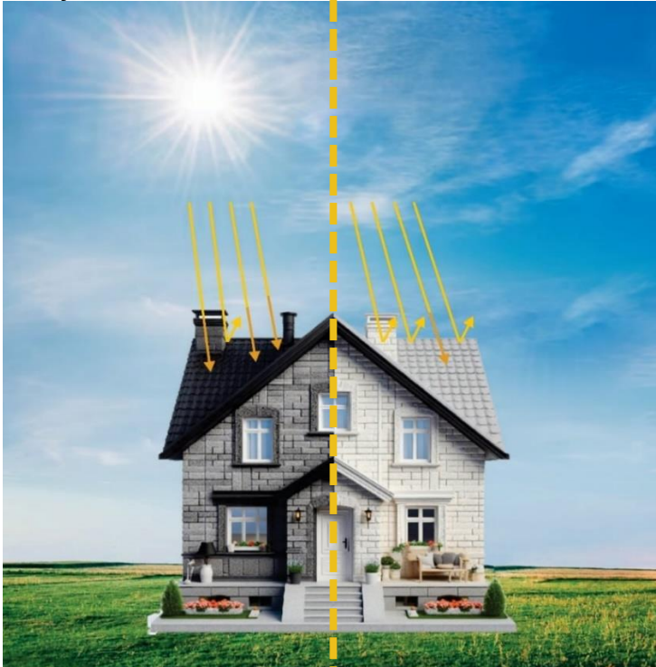
Figura 4 – Ilustração representativa da comparação da reflexão e absorção de calor entre os telhados escuros e brancos.
