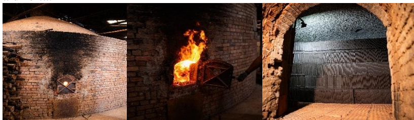
Figura 13 – Imagens do forno garrafão usado para a realização da queima com ciclos térmicos de 940°C e 157 horas, mostrando detalhes da estrutura externa, da fornalha e carregamento do forno da esquerda para a direita.
