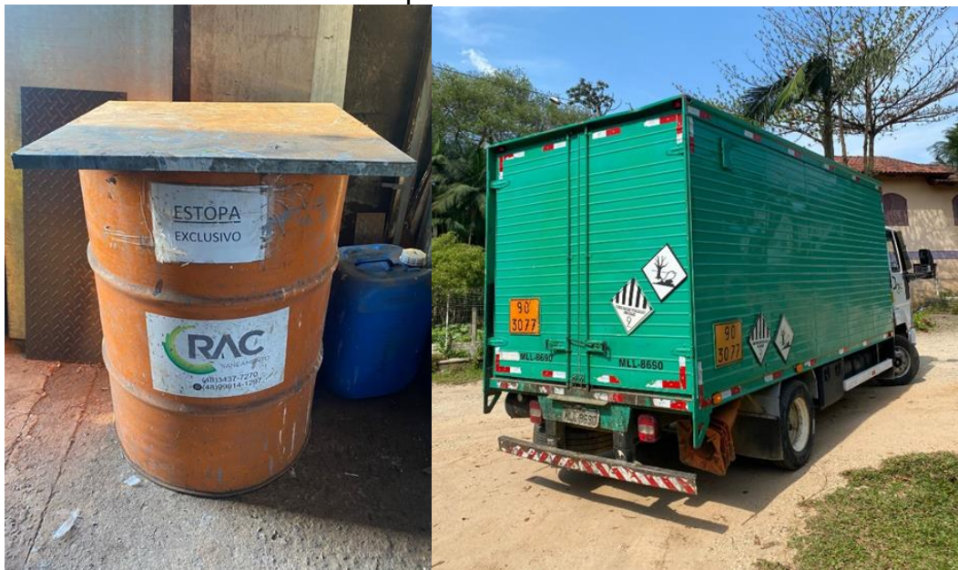
Figura 12: Separação de estopas com resíduos de óleo e graxa em seu devido latão, coleta dos resíduos industriais para o aterro industrial.
