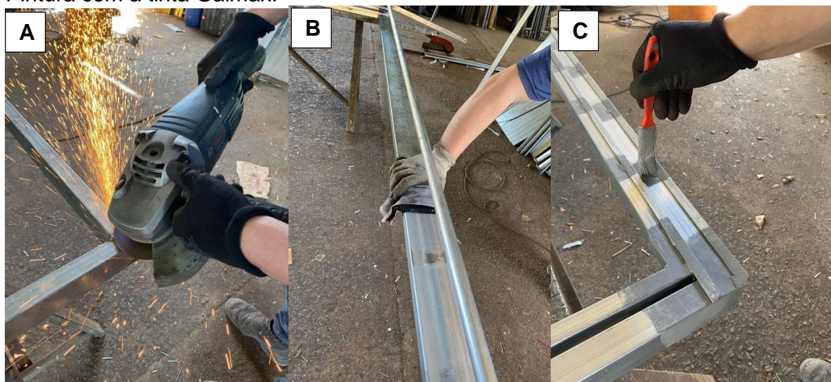
Figura 06: Etapa de acabamento. A: Desbaste da solda. B: Limpeza da peça. C: Pintura com a tinta Galmax.
