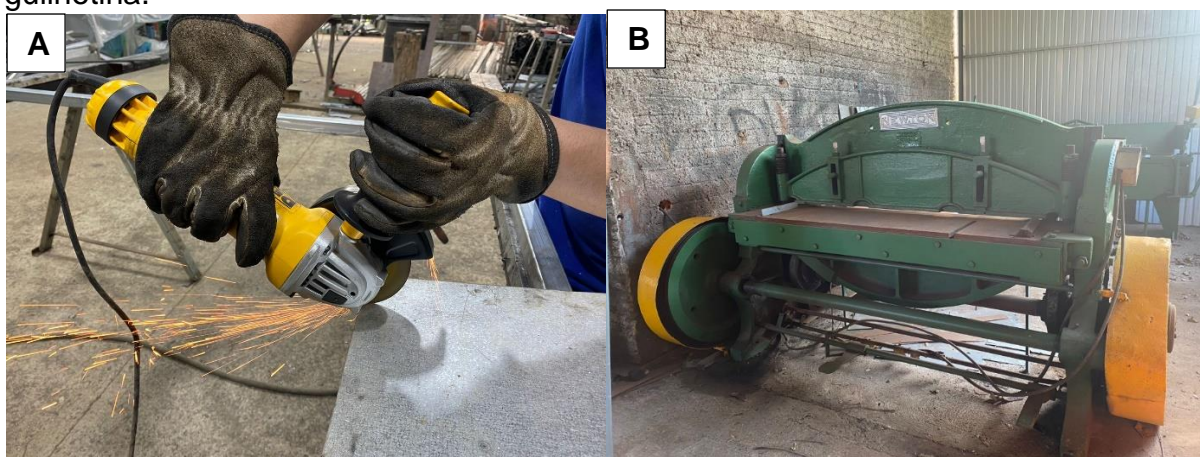
Figura 15: Substituição do método de corte A: Corte na esmerilhadeira, B: Corte na guilhotina.
