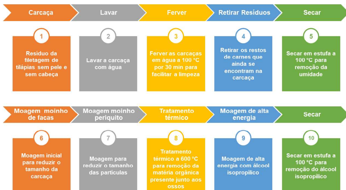
Figura 11 – Fluxograma de obtenção de HAP nanoestruturada.
