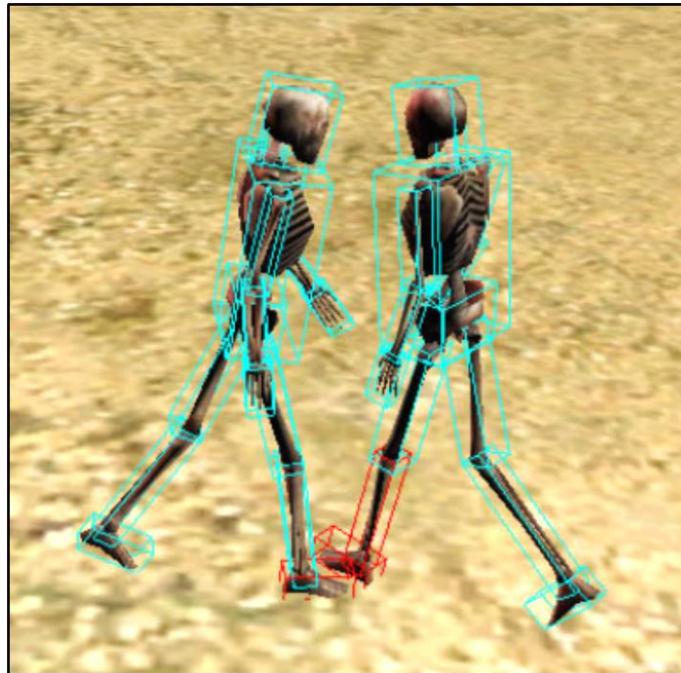
Figura 6 – Caixas de colisão
