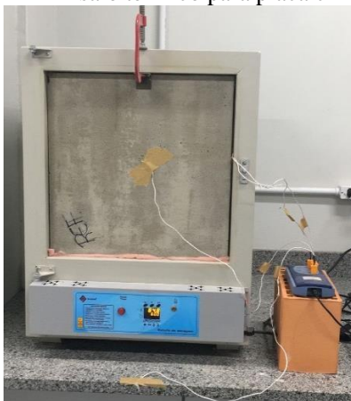
Figura 11 - Ensaio térmico para placa cimentícia.
