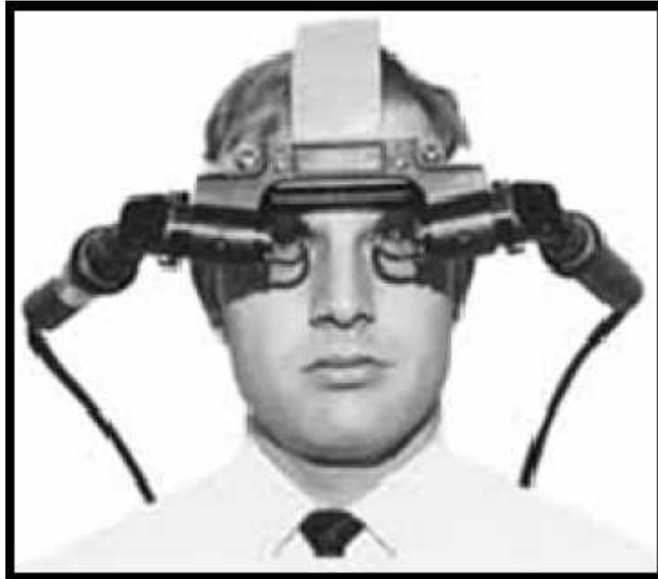
Figura 18 – Head-mounted display desenvolvido por Ivan Sutherland.
