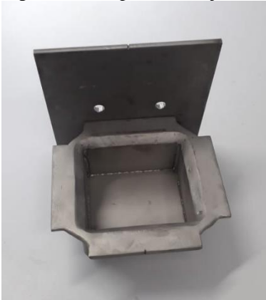
Figura 243 - Aparato de aço inox desenvolvido para produção do carvão
