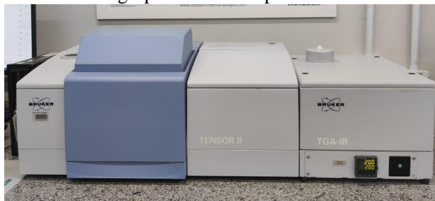
Figura 232 - Equipamento de transformada de Fourier utilizado para determinar os grupos funcionais presentes na biomassa
