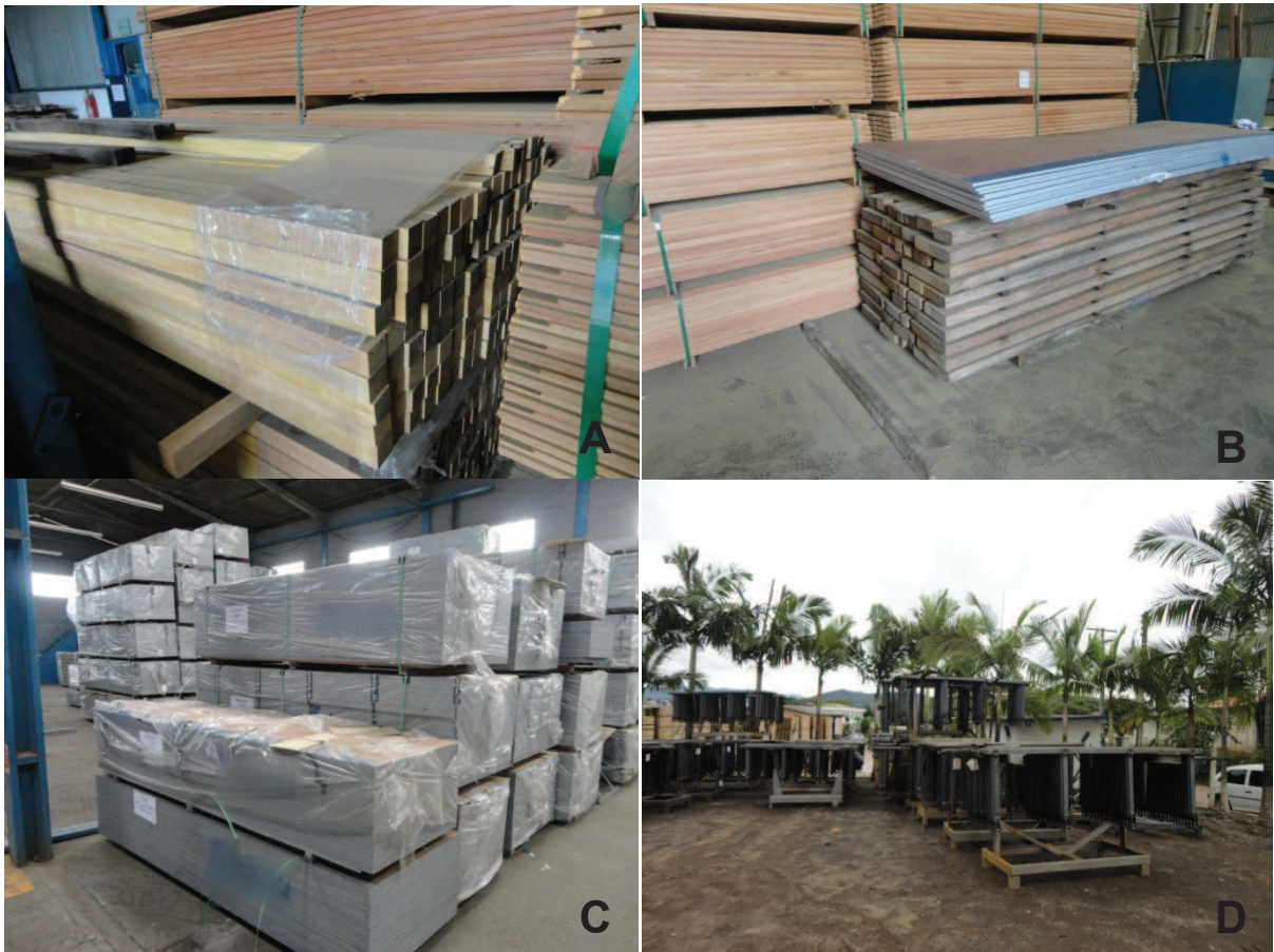
Figura 10 - Recebimento de matéria-prima - A) armazenamento das vigas pré-cortadas; B) armazenamento das vigas sem corte; C) armazenamento das placas em compensado naval; D) armazenamento de perfis, frontais e fueiros em aço advindos da unidade I.
