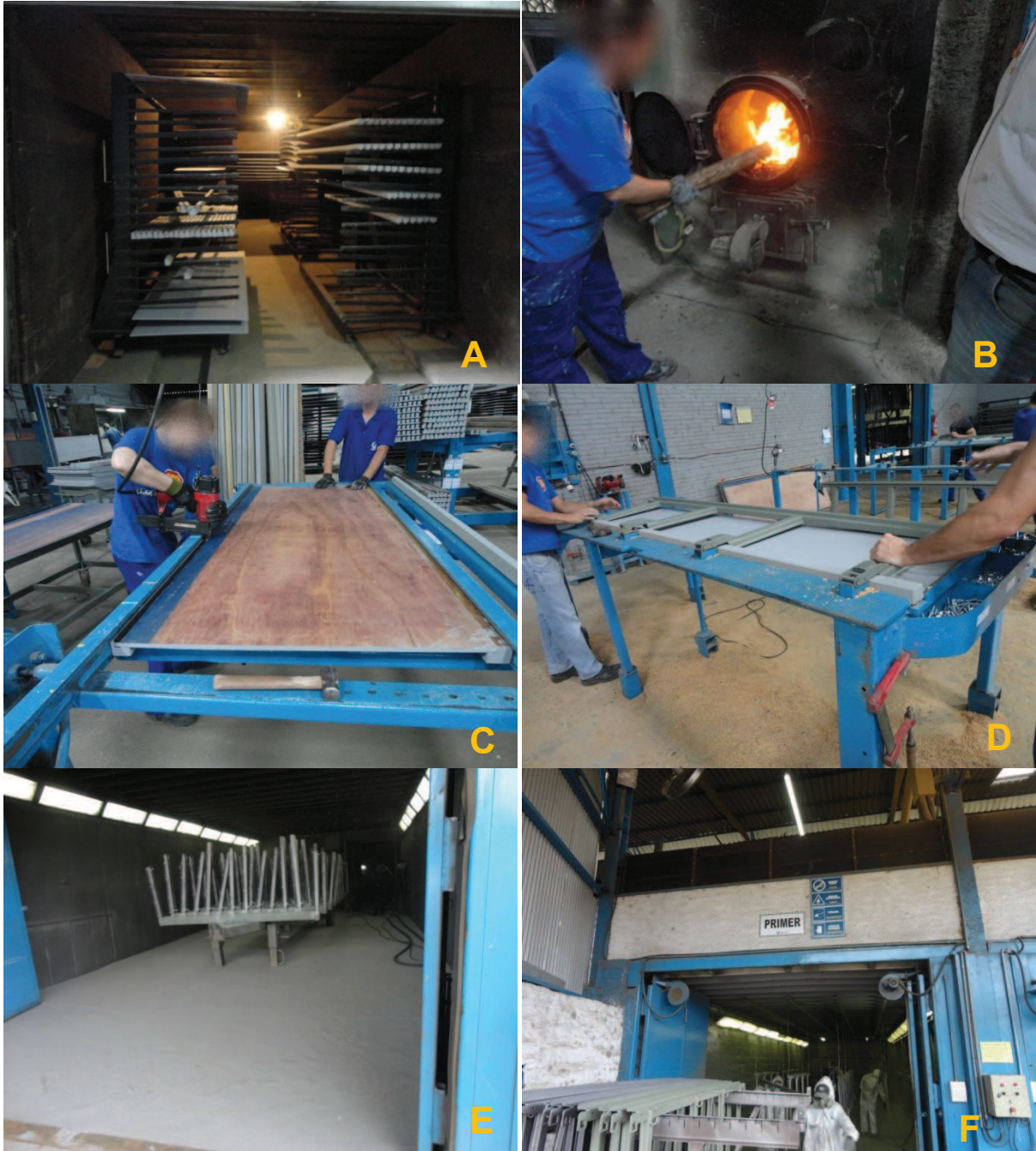
Figura 12 - A) vista interna da estufa de secagem; B) alimentação do forno da estufa; C) união das vigas com as placas em compensado naval e vadação; D) montagem do perfil em aço com as placas; E) vista interna da cabine do jato de granalha; F) aplicação do primer.
