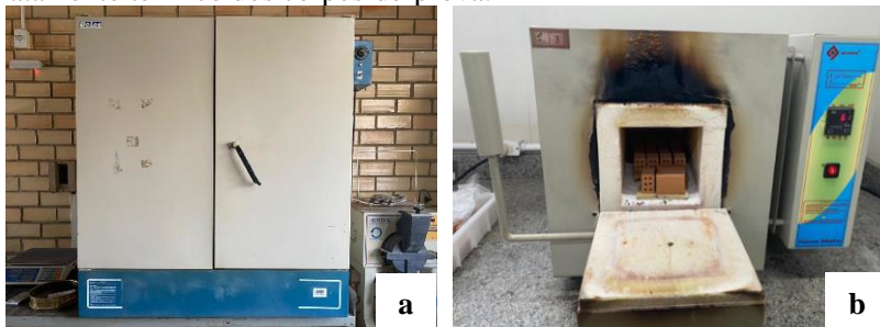
Figura 20 - Detalhe da estufa (a) e do forno mufla (b) utilizados no tratamento térmico dos corpos-de-prova.
