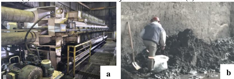
Figura 12 - Filtro prensa relacionado ao processo de beneficiamento do carvão (a) e o instante da coleta do rejeito fino de carvão (b).
