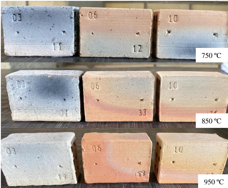
Figura 31 - Detalhe dos CPs indicando a presença de coração negro nas formulações F.3, F.6 e F.10, sob as temperaturas 750 °C, 850 °C e 950 °C.
