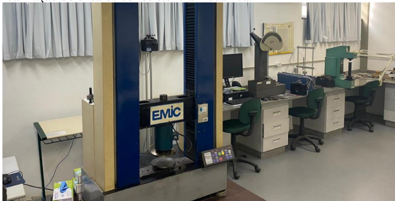
Figura 21 - Máquina universal de ensaios mecânicos utilizado para a realização de ensaios de resistência mecânica.
