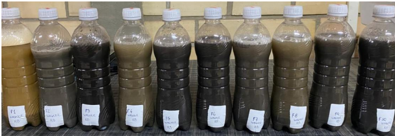
Figura 15 - Preparação de suspensões das amostras para o ensaio de resíduo bruto.
