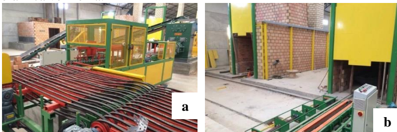
Figura 3 - Representação de uma extrusora e de cortador de peças (a), bem como da boca de entrada de forno contínuo (b) na produção de cerâmica vermelha.
