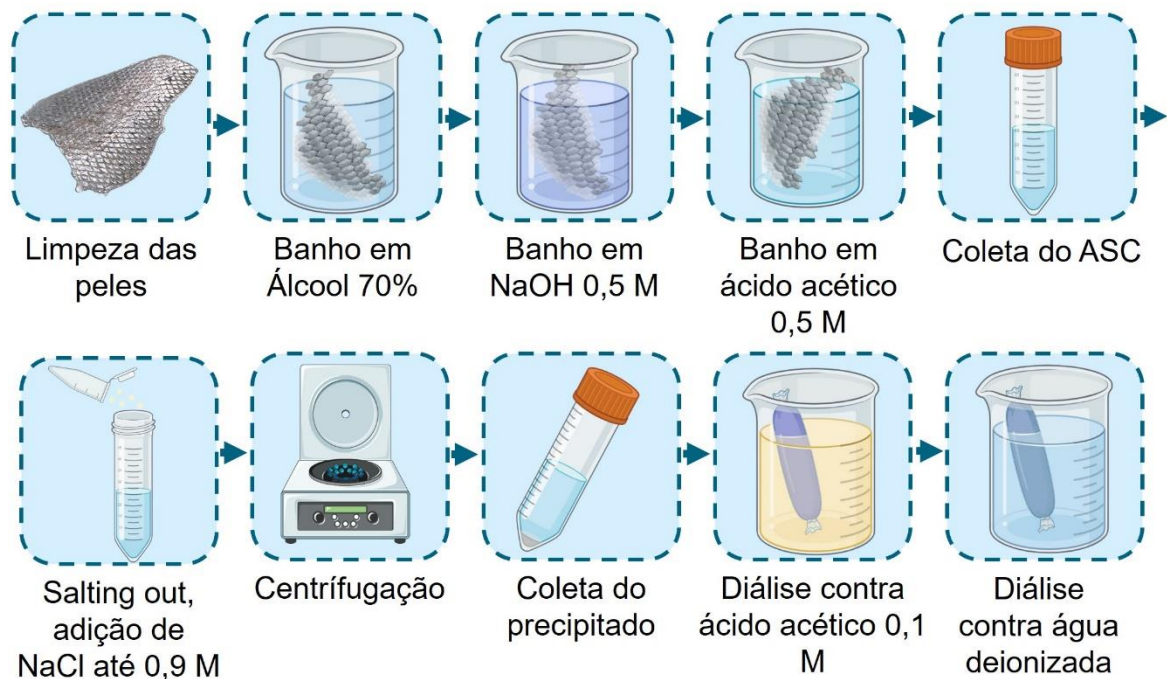
Figura 12 Representação esquemática da obtenção e purificação de colágeno pelo método ASC.
