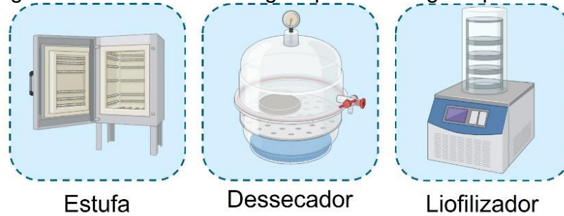
Figura 13 Métodos de secagem para o colágeno purificado.
