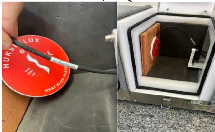
Figura 18: (a) Sensor de fluxo de calor; b) Fixação do sensor de fluxo à amostra.
