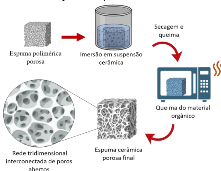
Figura 7: Esquema ilustrativo das etapas envolvidas na técnica da réplica para obtenção de espumas cerâmicas.
