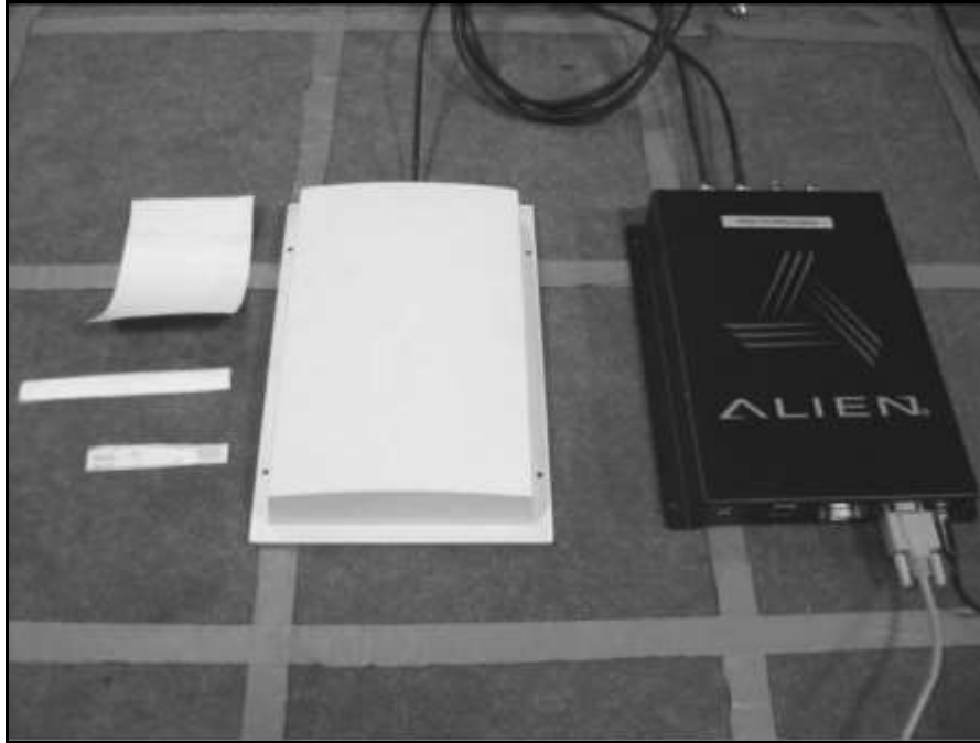
Figura 11 – Um leitor (preto), antena (branco) e 3 tipos de tags.
