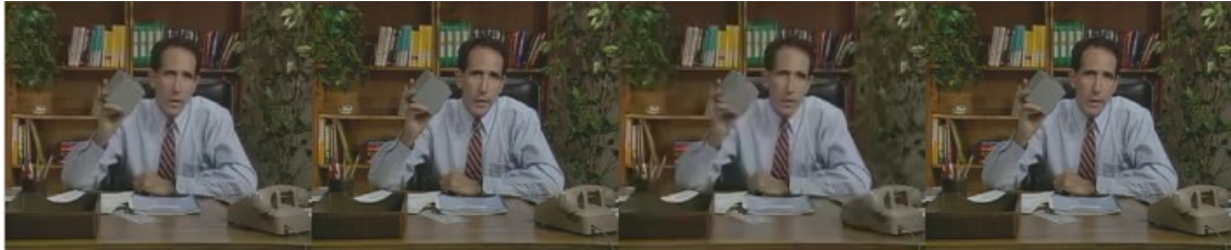
Figura 32 - Quadros decodificados da sequência Salesman: (a) H.264/AVC 32 kbps (b) H.264/AVC 1024 kbps (c) H.265/HEVC 32 kbps (d) H.265/HEVC 1024 kbps.
