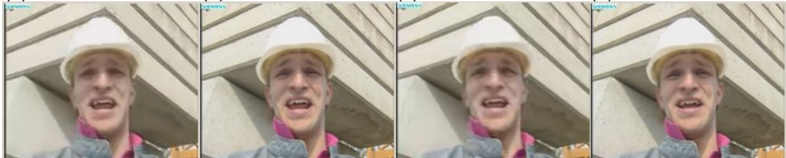
Figura 24 – Quadros decodificados da sequência Foreman: (a) H.264/AVC 32 kbps (b) H.264/AVC 1024 kbps (c) H.265/HEVC 32 kbps (d) H.265/HEVC 1024 kbps.
