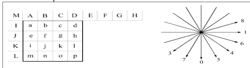
Figura 5 - Esquerda: predição Intra 4x4 é aplicada para amostras a-p utilizando amostras A-M. Direita: Oito "direções de predição" selecionáveis para modo Intra 4x4.
