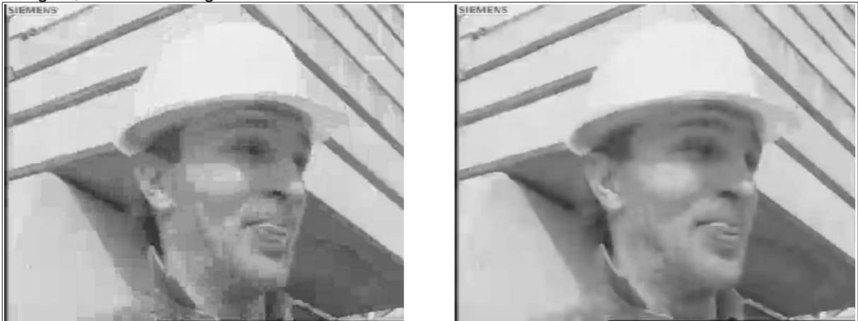
Figura 8 – Desempenho do filtro de deblocação para imagens altamente comprimidas. Esq.: Sem filtragem; Dir.: Com filtragem.
