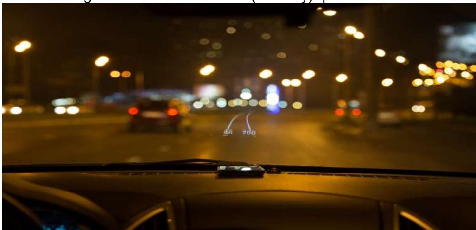
Figura 8 - Sistema de GPS (Hudway) que utiliza RA.
