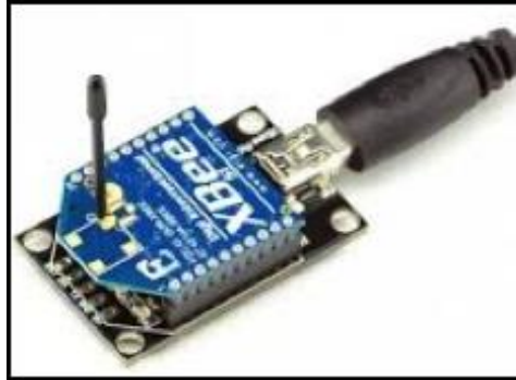
Figura 19 – Modulo Xbee acoplado ao explorer USB adapter.
