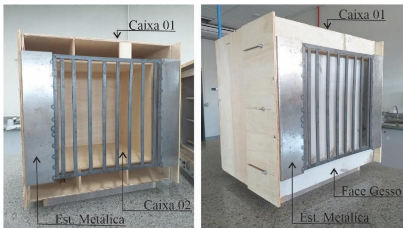
Figura 19 – Imagem do aparato térmico desenvolvido.
