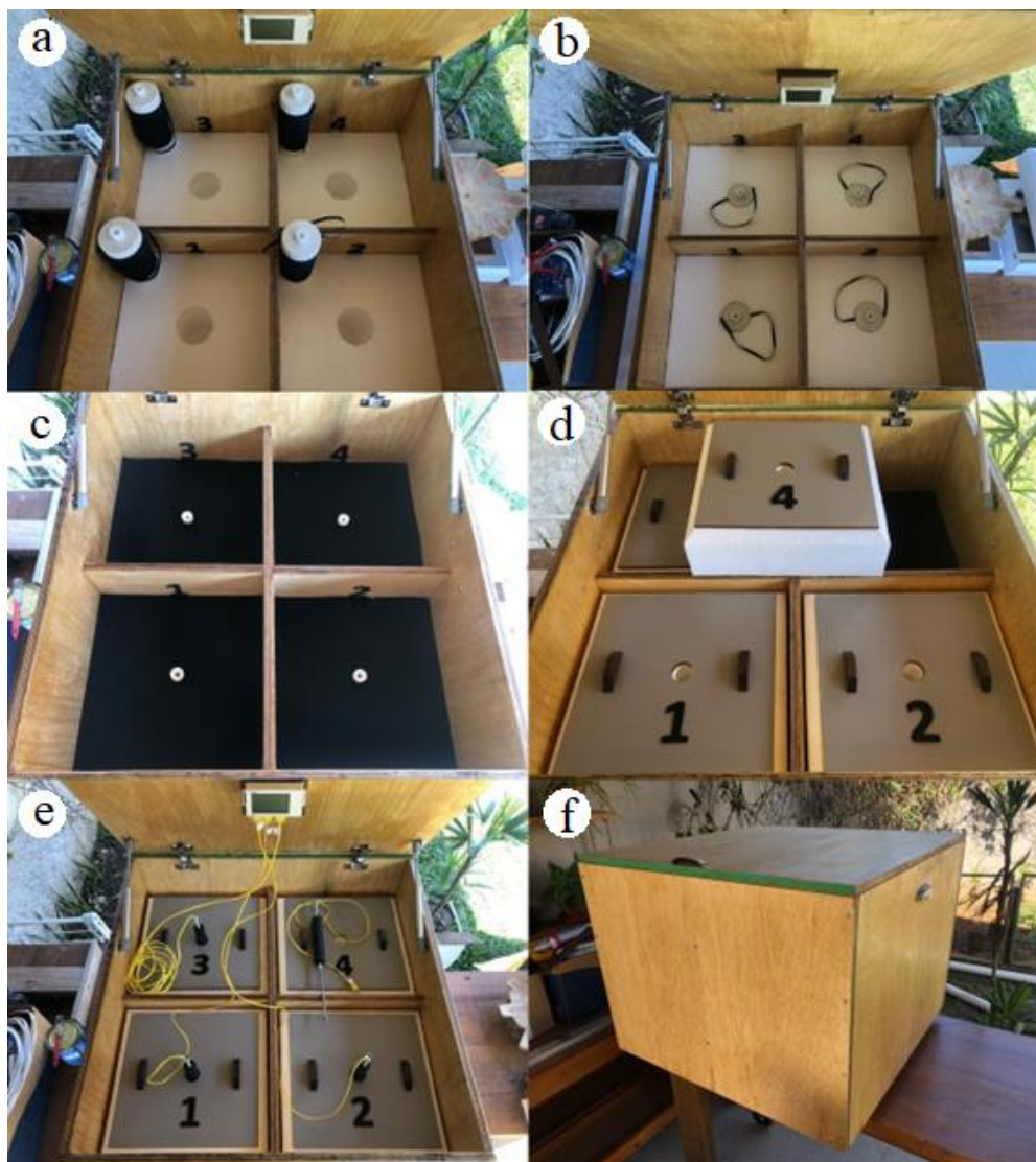
Figura 3-9: Imagens do calorímetro semi-adiabático utilizado: a) cápsulas; b) detalhe das cápsulas inseridas nas células; c) colocação da manta de isolamento interna; d) tampa superior de cada célula; e) sondas tipo espeto utilizadas; f) aspecto do equipamento fechado em operação.
