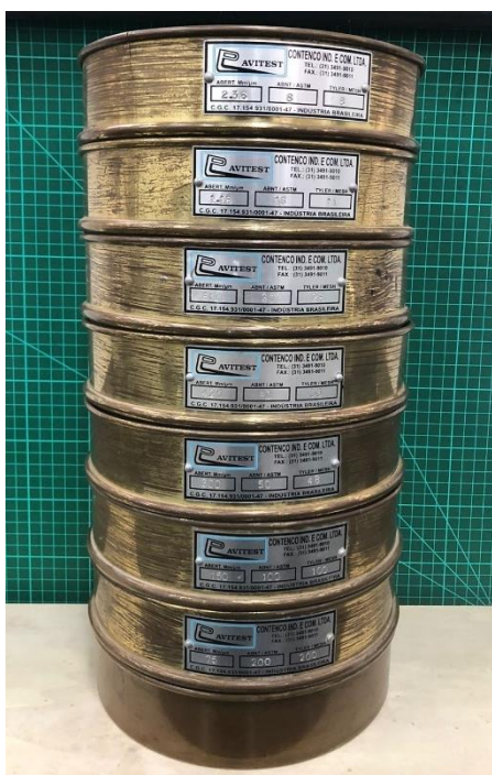
Figura 3-6: Conjunto de peneiras utilizadas: 1,18 mm, 600 \mu\text{m} , 425 \mu\text{m} , 300 \mu\text{m} , 150 \mu\text{m} , 75 \mu\text{m} e fundo.
