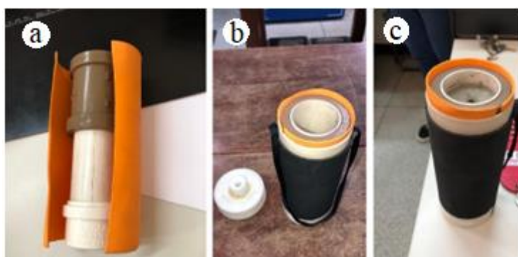
Figura 3-11: Aparato para redução de volume da amostra: a) imagem do artefato redutor de volume; b) artefato instalado na capsula; c) capsula preenchida com pasta.
