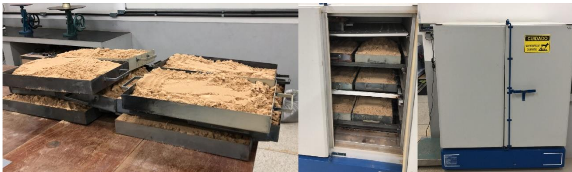
Figura 3-2: Imagem da secagem do agregado miúdo em estufa a 100 °C.
