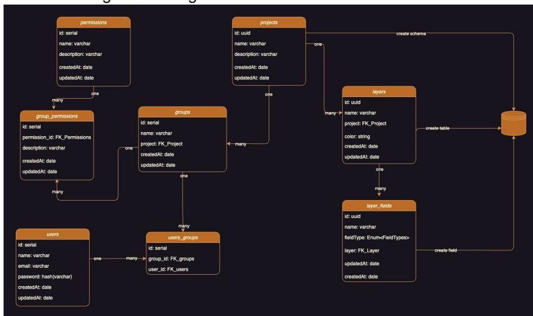
Figura 1 - Diagrama de classes do banco de dados
