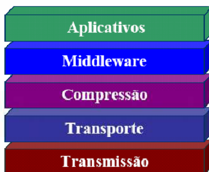
Figura 4. Arquitetura de um sistema de TV Digital Fonte: CAPDA, 2004
