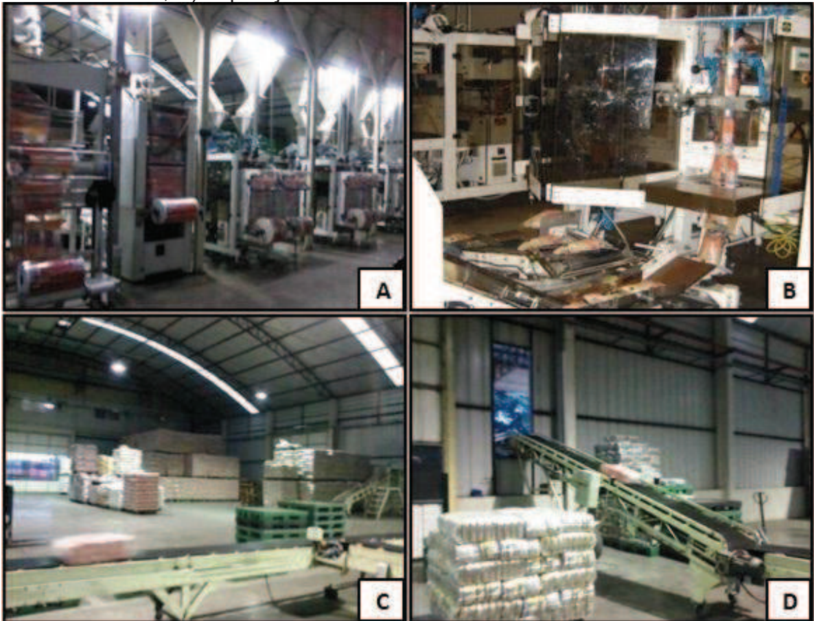
Figura 12 – A) Máquinas de empacotamento; B) Empacotamento do produto; C) Armazenamento; D) Expedição
