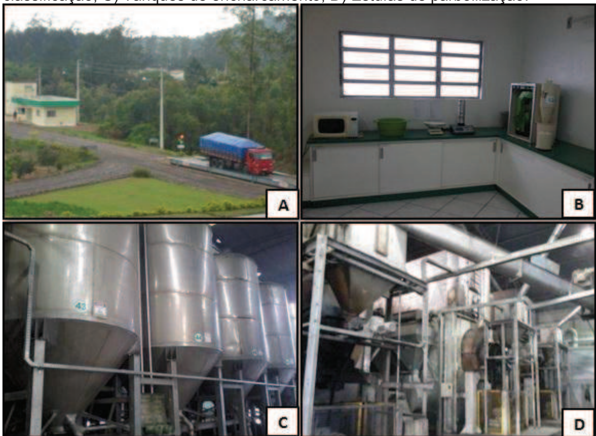
Figura 07 – A) Recebimento da matéria-prima/pesagem; B) Laboratório de classificação; C) Tanques de encharcamento; D) Estufas de parboilização.
