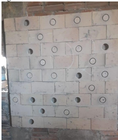
Figura 5 - Parede refratária durante ensaio de arrancamento.
