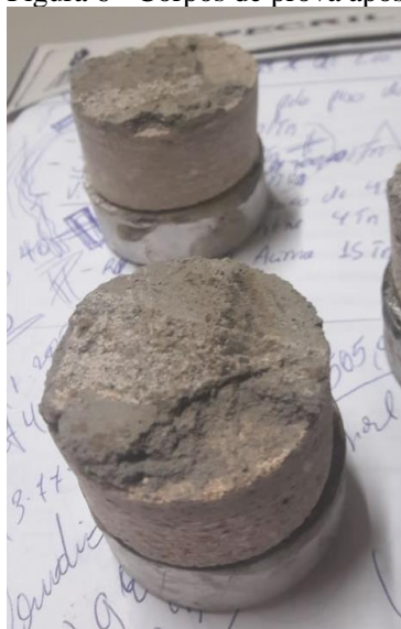
Figura 6 - Corpos de prova após ensaio de arrancamento.
