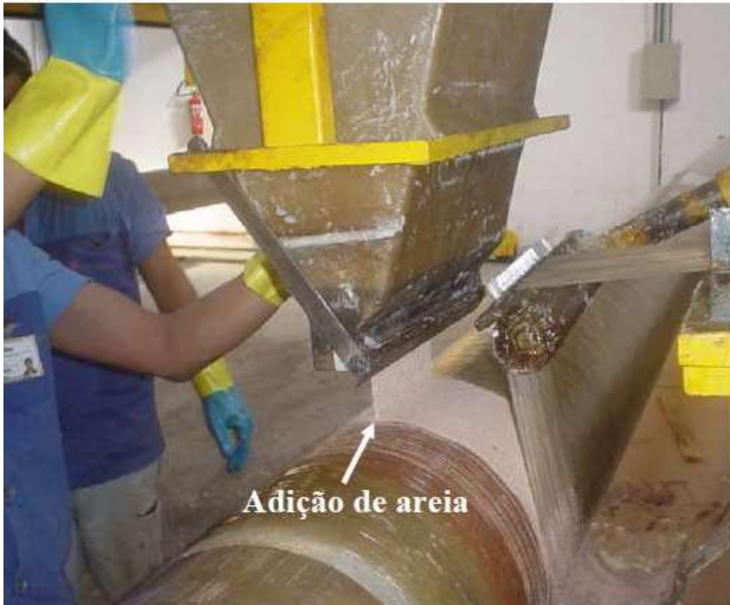
Figura 05. Utilização de areia na fabricação de tubos em PRFV.
