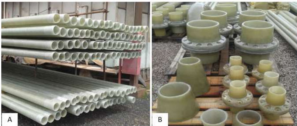
Figura 02. Tubulações produzidas em compósito (A), acoplamentos em poliéster reforçado com fibras de vidro (B).
