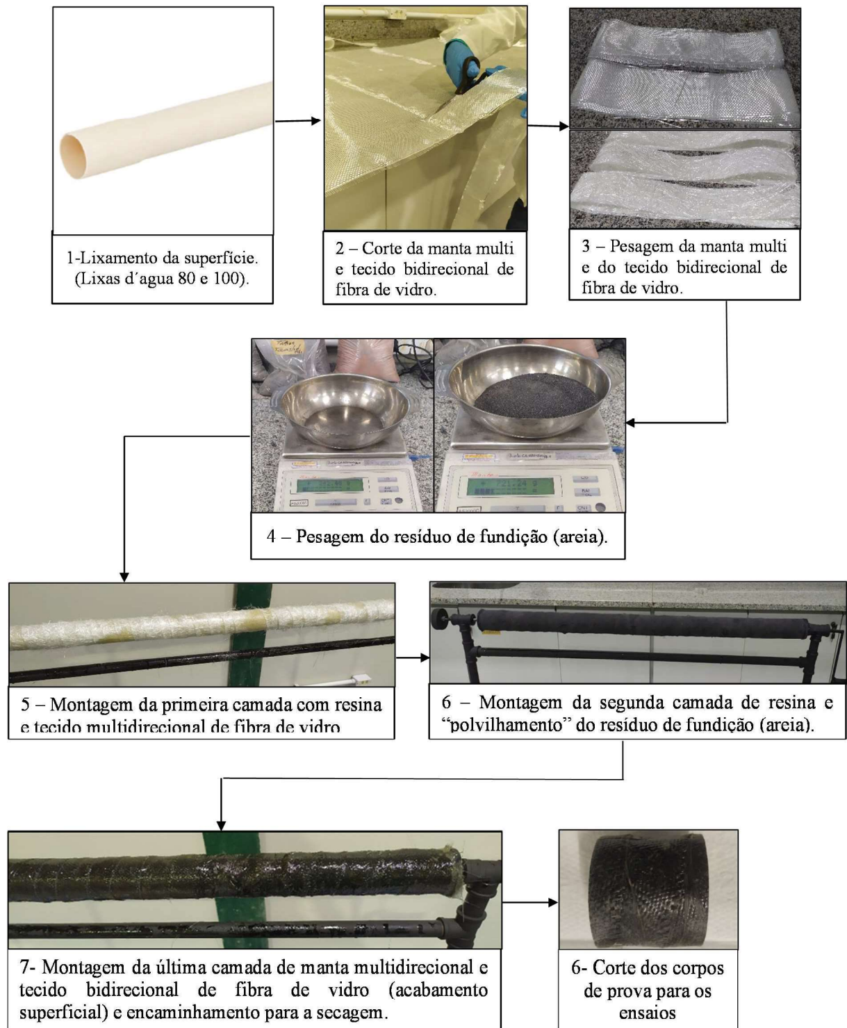
Figura 10. Fluxograma das etapas de fabricação do tubo RPVC com adição de resíduo de areia descartada do processo de fundição.
