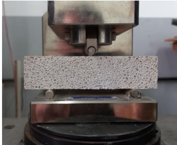
Figura 16. Determinação da Resistência à flexão das amostras
