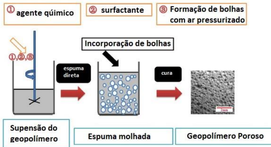
Figura 4. Esquema típico para formação de espuma direta
