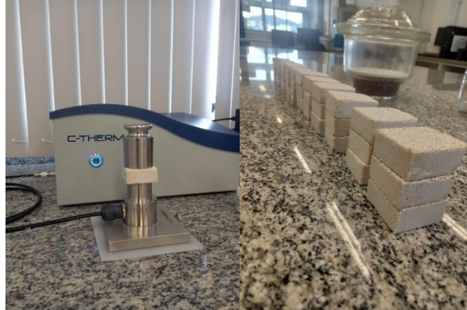
Figura 17. Medição da condutividade térmica em equipamento C-Therm
