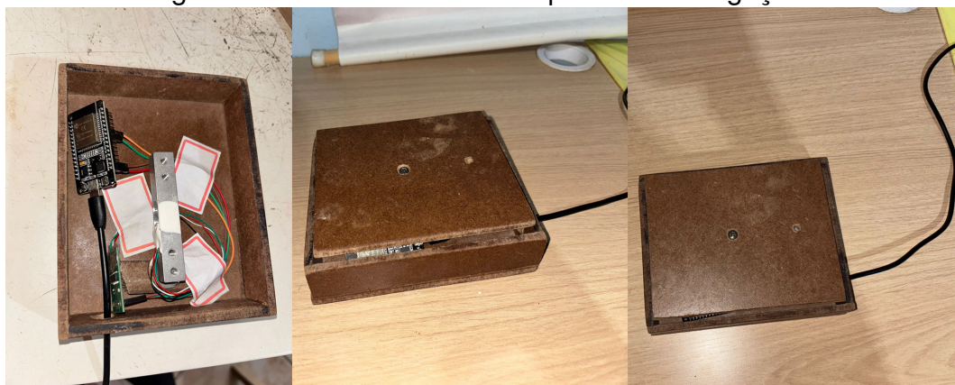
Figura 2 - Estrutura construída para fixar as ligações
