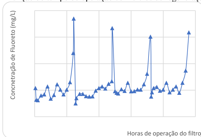
Figura 64 – Concentração de fluoreto no efluente da coluna de adsorção em função do tempo de operação com ciclos de regeneração.
