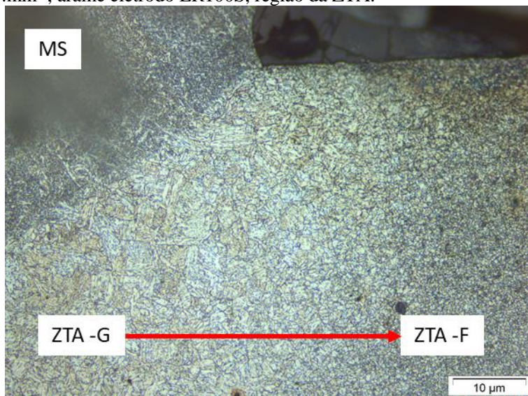
Figura 55 - Amostra curto circuito na energia de soldagem de 0,5 a 0,6 \text{kJ}\cdot\text{mm}^{-1} , arame eletrodo ER100S, região da ZTA.
