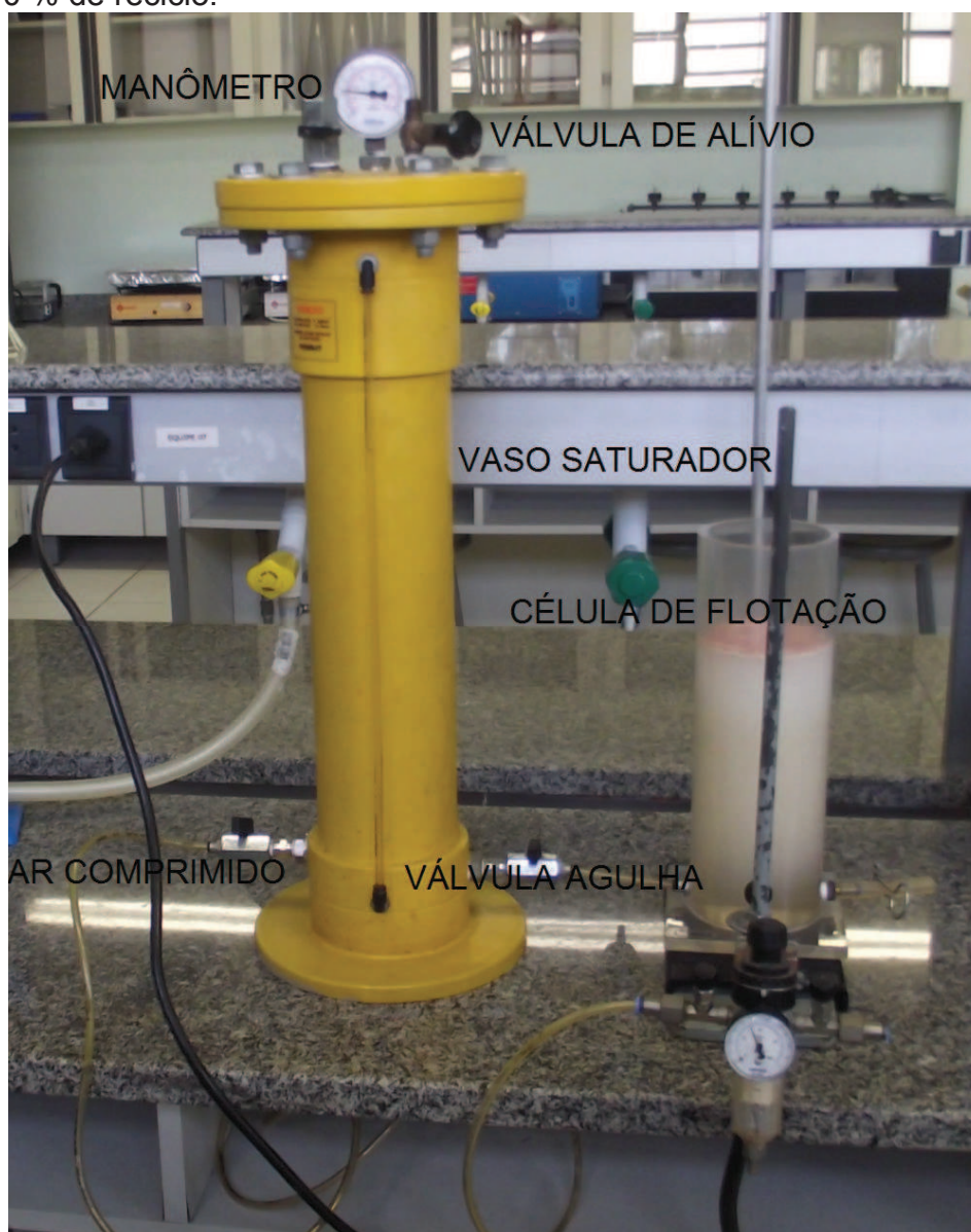
Figura 04 - Flocos adquirindo movimento ascendente após adição de microbolhas de ar com 40 % de reciclo.
