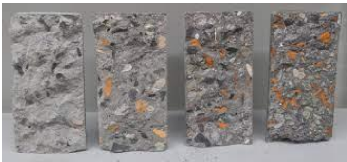
Figura 82: Corpos de Prova com inclusão de cerâmica no concreto
