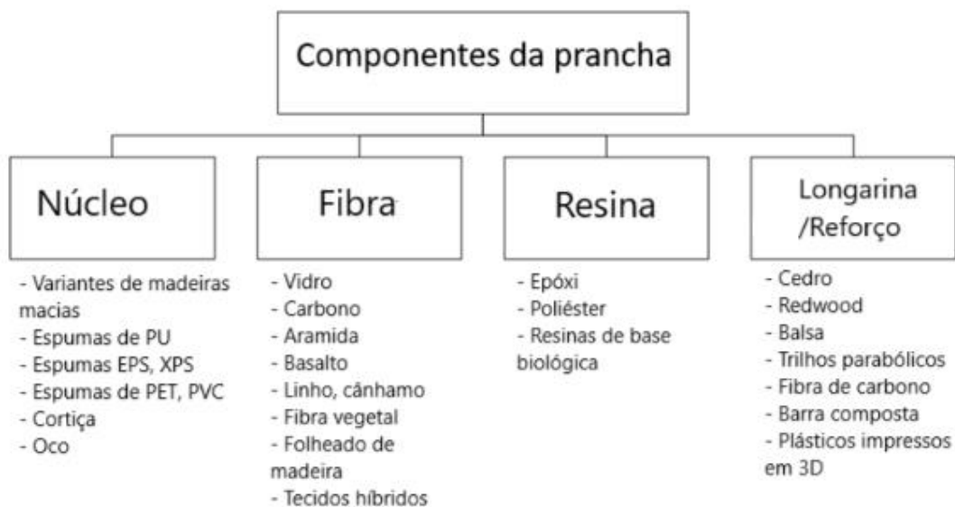
Figura 3 - Componentes típicos de pranchas de surfe e os materiais mais utilizados. Adaptado de Crameri et al. (2023), Oliveira (2019) e Sheppard (2018).
