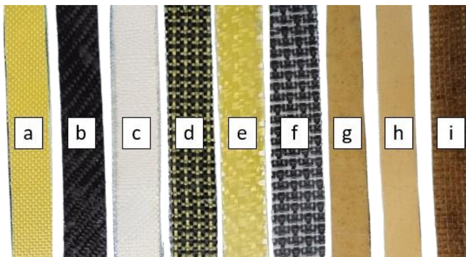
Figura 11 - Imagem fotográfica dos compósitos produzidos com resina epoxídica e tecidos de: (a) aramida, (b) carbono, (c) vidro, (d) aramida/carbono, (e) aramida/vidro, (f) carbono/vidro, (g) algodão, (h) linho e (i) juta. Fonte: Autor (2025)
