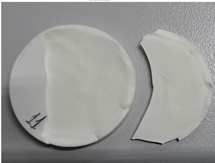
Figura 37 - Imagem de um corpo de prova após realização do ensaio de resistência a flexão biaxial.
