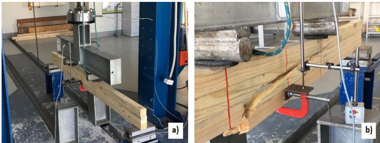
Figura 07 – a) Ensaio de flexão estática à quatro pontos; b) viga rompida após ensaio de flexão estática à quatro pontos
