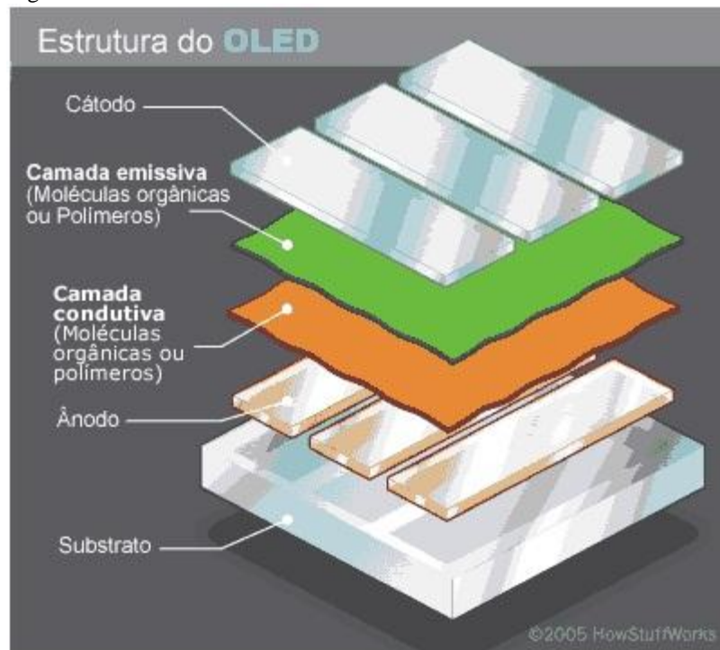
Figura 6- Ilustra a estrutura de um OLED comum.
