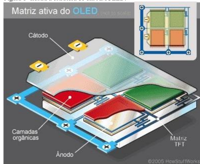
Figura 8- Ilustra a estrutura de um AMOLED.
