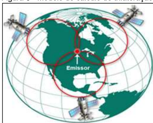
Figura 6 - Modelo de cálculo de trilateração
