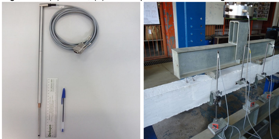
Figura 7 – (a) LVDT; (b) LVDTs posicionados na viga.
